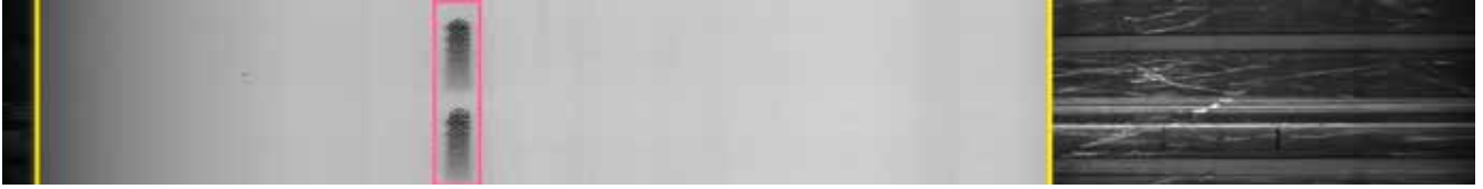
Bild 2. Blob: Das System hat einen winzigen verschmutzten Bereich links vom rosa eingerahmten Druckbereich gefunden (© Strelen)
